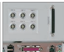
内置数字I/O和计数器/ 编码器接口 (可选装)
